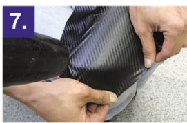
7. 角などのアールのきつい部分はドライヤーで温めながら、ゆっくりと伸ばすように貼付けて下さい。
