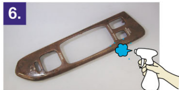
6. 貼付け面にきりふき等を使用し、水100:石鹸1の割合で混ぜた物を吹き付けます。こうするとすぐに接着せず、位置決めが自由にでき、気泡も取りやすくなります。
