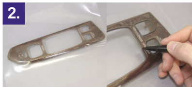
2. 同封の型取り用透明シートを、型取りを行う場所にテープ等で貼付け、油性マジックで型取りを行って下さい。
