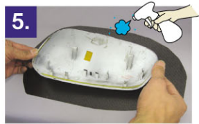
5. 本商品の剥離紙を剥がし、位置を確認しながら貼付けていきます。(貼付け面にきりふき等を使用し、水100:石鹸1の割合で混ぜた物を吹き付けます。こうするとすぐに接着せず、位置決めが自由にでき、気泡も取りやすくなります。)
