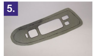
5. 型取りを行ったラインより大きめにハサミ等で丁寧にカットします。カットが出来ましたら透明シートを剥がして下さい。
