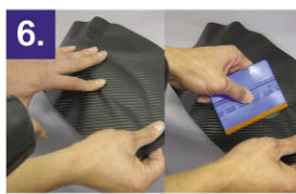
6. ドライヤーで温めながら、気泡が入らないようにゴムヘラ等を使用し丁寧に貼付けていきます。
